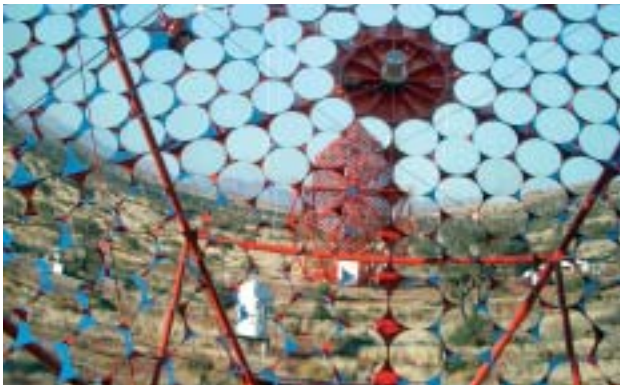
Die namibische Landschaft und ein weiteres Teleskop spiegeln sich im Reflektor eines der H.E.S.S.-Teleskope. Das H.E.S.S.-System besteht aus vier großen Teleskopen und weist hochenergetische Gammastrahlung aus dem Kosmos nach.
