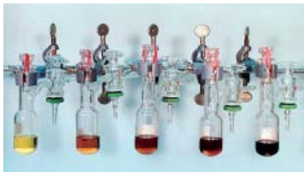
Lösungen unterschiedlicher Platin- und legierter Platin-Nanocluster, die auf ihre Eignung als effiziente Brennstoffzellen-Katalysatoren hin untersucht werden.
